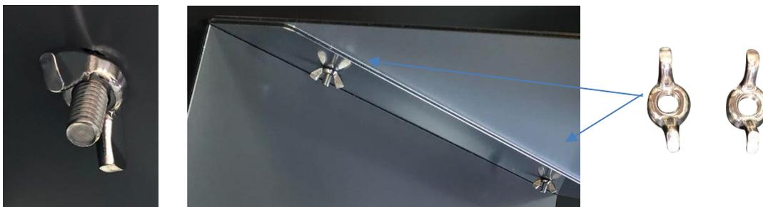
Nehmen Sie zwei der Sperrzahnschrauben M8 und schrauben diese **fest** auf die Gewindebolzen auf.
